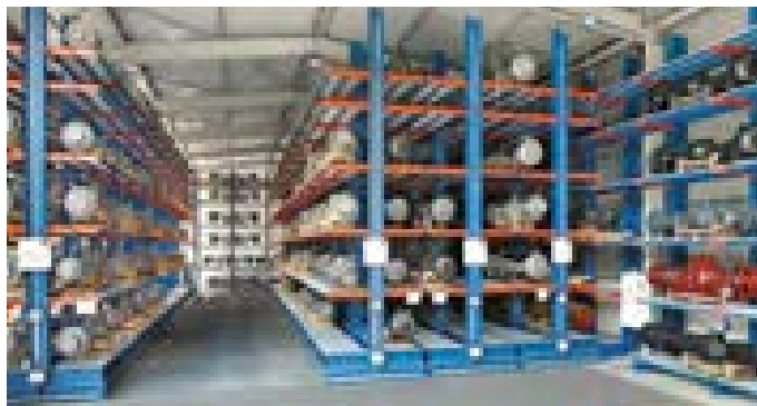
Verschieberegalanlage Steigerung der Lagerkapazität um 110% = 21 Regalzeilen
